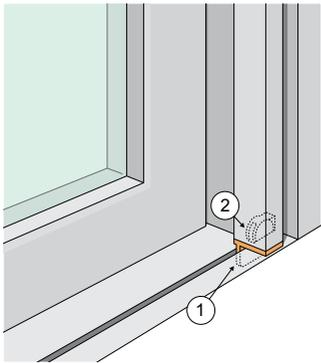
5. AutoLatch™-Schrauben an den Verschlussstellen oben und unten. Diese befinden sich oben und unten an den Flügeln, an denen sich der verdeckte Türgriff befindet.
