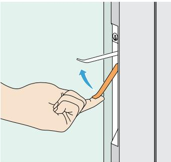
Wenn Sie einen schlüsselbetriebenen AutoLatch™-Riegel haben, können Sie die Tür zusätzlich mit einem Schlüssel zuschließen. Der Schlüsselzylinder ist im Türrahmen neben dem Glas versteckt und der Schließmechanismus ist eine 45°-Drehung des Schlüssels. Sie hören ein deutliches Klicken. Der Türdrücker kann nach Verschließen nicht mehr bedient werden.
