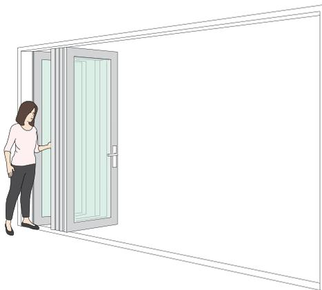
Drücken Sie leicht auf die gestapelten Türflügel und stellen Sie sicher, dass der Zugangsflügel flach auf dem nächsten Türflügel aufliegt.
