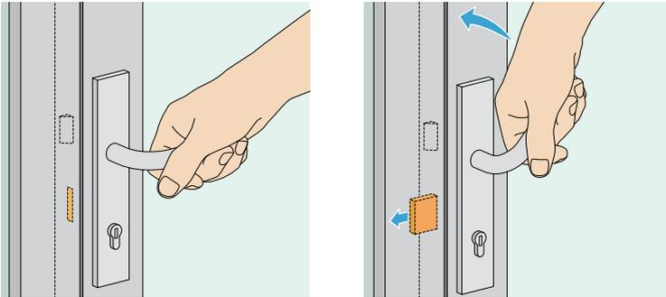
2. Verschließen Sie den Mechanismus durch Drehen des Knaufs um 360°. (Achtung: Der Knauf oder Schlüssel lässt sich nur in eine Richtung drehen). Nach Verschluss der Tür lässt sich der Türdrücker sowohl von draußen als auch drinnen nicht mehr bedienen – prüfen Sie dies, indem Sie versuchen, die Tür zu öffnen.
