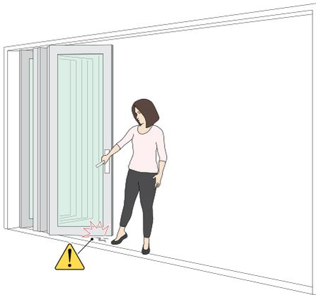
Wenn Sie den Zugangsflügel nutzen, um die Tür zu schließen, könnte die äußere Kante des Zugangsflügels über den Boden schleifen und so Boden und Türen beschädigen.
