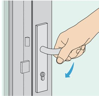
2. Öffnen Sie die Tür, indem Sie den Griff nach unten drücken. Dies löst die Bolzen und ebenso den Türdrücker.
